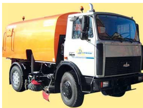
Рис. 6.12. Вакуумная подметально-уборочная машина ВПМД-01.
