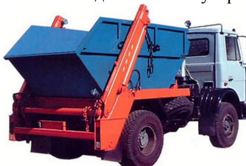
Рис. 4.31. Бункеровоз МКС-3501 на шасси МАЗ-5551А2
