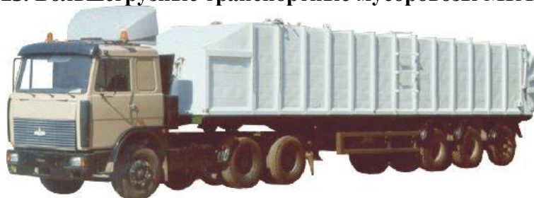
Рис. 4.24. Мусоровоз МКТ-150 на шасси МАЗ
