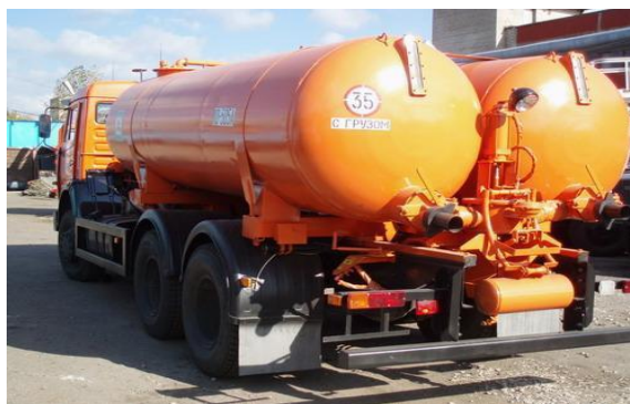
Рис. 5.5. Вакуумная машина КО-505А на шасси КамАЗ-65115-71
