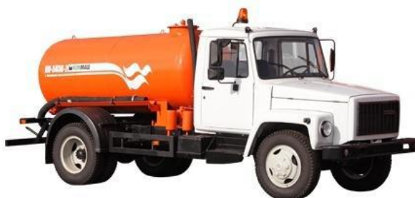
Рис. 5.4. Вакуумная машина КО-503В-2 на шасси ГАЗ-3309
